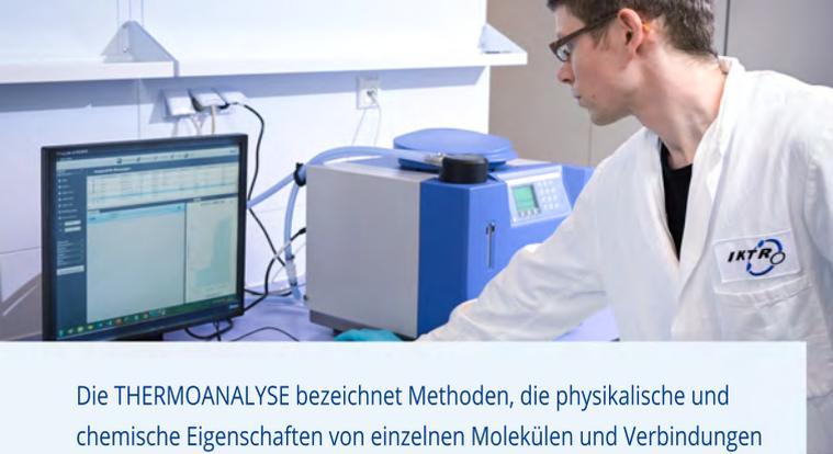
Die THERMOANALYSE bezeichnet Methoden, die physikalische und chemische Eigenschaften von einzelnen Molekülen und Verbindungen ermitteln. Die dabei erhaltenen Spektren können zur Charakterisierung bzw. Identifizierung von Molekülen sowie Verbindungen verwendet werden. Anhand dieser können Schadensanalysen, Reklamationsbewertungen oder Vergleichsstudien von Produkten erfolgen.
